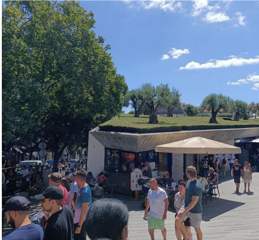
Cubierta vegetal de césped y olivos sobre el centro comercial del Jardim das Oliveiras
